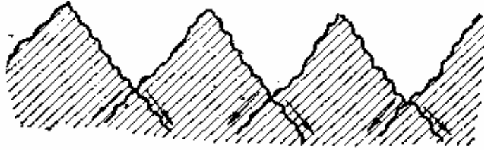
Рис. 50. Схема разрушения металла от коррозии.
